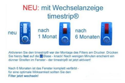
Das patentierte timestrip® - System zeigt Ihnen den Zeitverlauf und erinnert Sie nach 6 Monaten zuverlässig den FIlter zu wechseln. Unnötige Fein- und Nanopartikelbelastung, hervorgerufen durch eventuell erschöpften Filter wird so vermieden. Die tatsächliche Belastung des Filters richtet sich nach der Betriebsdauer und der Emissionen Ihres Druckers.
